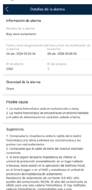
Figura D-1 Detalles de la alarma
