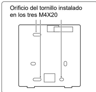
Orificio del tornillo instalado en los tres M4X20
